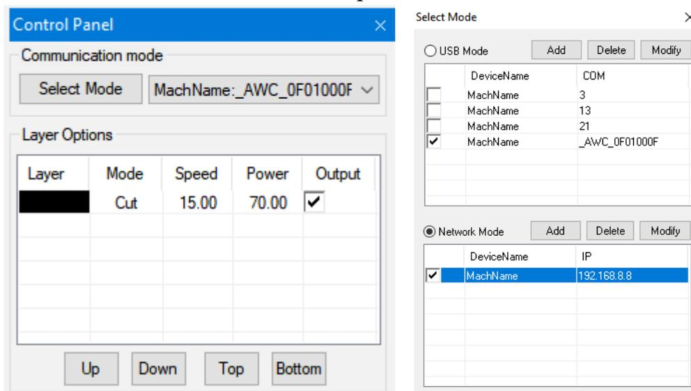
В окне “Select Mode” выбираем режим Network Mode, выбираем необходимое устройство, нажимаем “Modify” и изменяем при необходимости IP контроллера в окне Device IP. Нажимаем “OK”, закрываем окно “Select Mode”.
