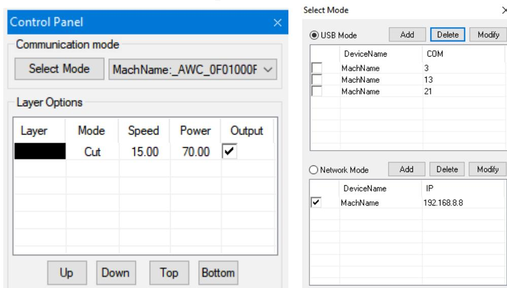
В окне “Select Mode” выбираем режим USB Mode и добавляем новое устройство “Add”, в окне USB Com нажимаем на клавишу FindCom. Нажимаем “OK”, закрываем окно “Select Mode”. Подключение выполнено.
