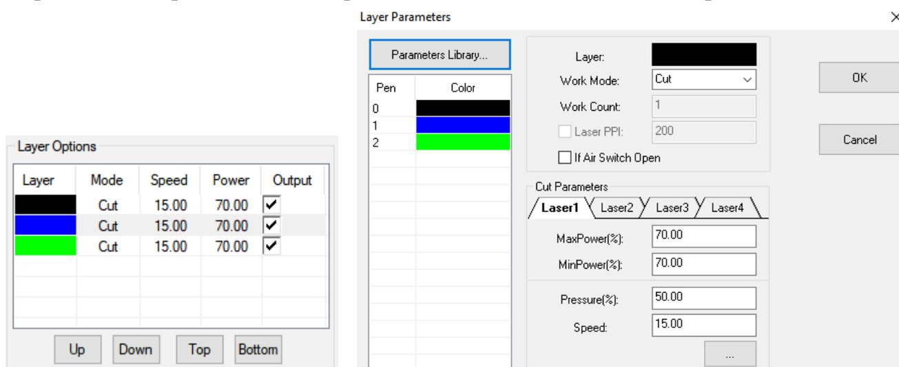
Для редактирования слоя необходимо дважды щёлкнуть левой клавишей мыши на соответствующей строке таблицы в окне “Control Panel”. Наиболее важными параметрами являются “Output” (обрабатывать на станке), “Speed” (скорость
