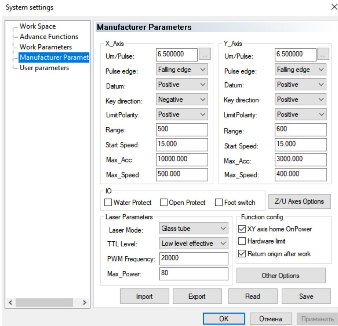
Параметры группы “User Parameters” находятся в меню “Options>>System Options...>>User Parameters”. Считываем текущие параметры контроллера “Read”, выбираем файл профиля “Import>>user.cf5”, затем “Save”. Пароль для подтверждения внесённых изменений “608”.
