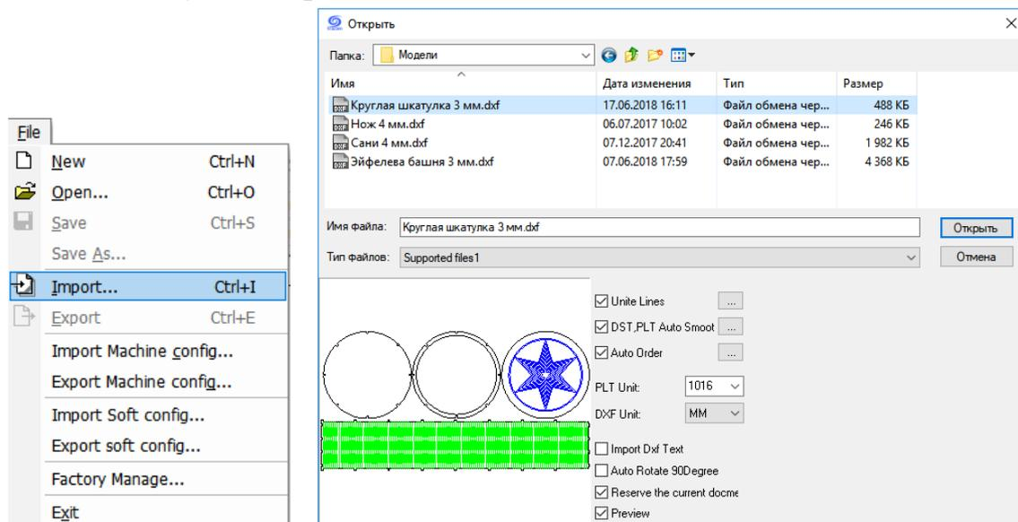
Если графический файл был подготовлен с использованием различных слоёв, то при импорте элементы каждого слоя будут выделены различными цветами из палитры программы.
