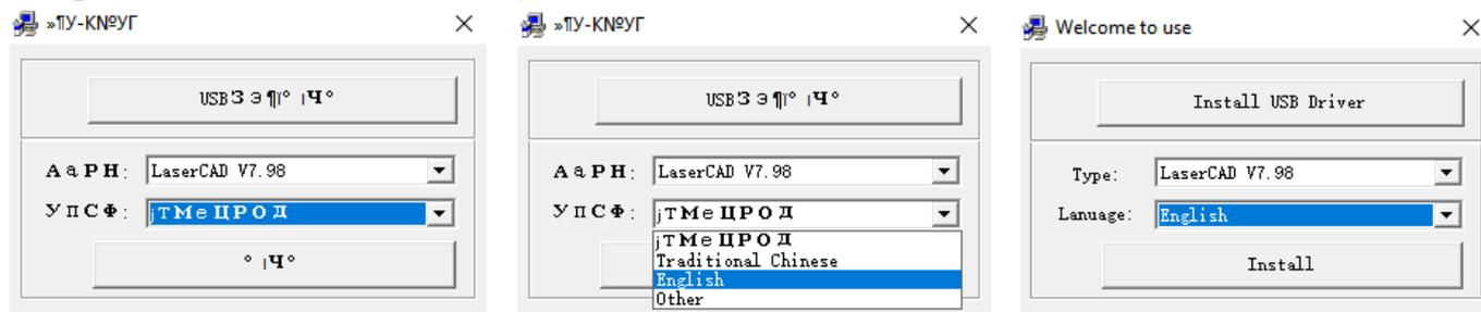
Сперва необходимо установить драйвер “Install USB driver” контроллера управления, предварительно запустив станок и подключив его по USB к компьютеру (разъём USB). При запуске будет выполнена процедура определения домашнего положения портала станка (лазерной головки). Далее устанавливается программное обеспечение LaserCAD “Type>>LaserCAD>>Install” или плагин для стороннего графического редактора ”Type>>Plugin ...>> Install”.
