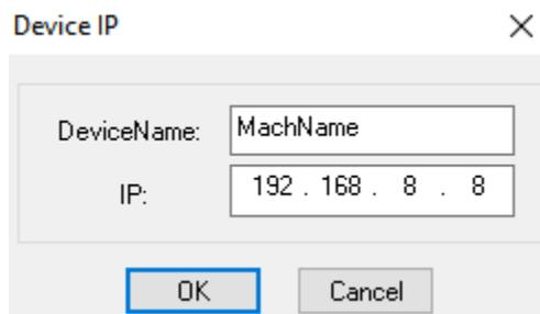
В сетевых настройках компьютера устанавливаем устанавливаем IP адрес в подсети контроллера, например 192.168.8.1 и соответствующую маску. настраиваем необходимые разрешения в случае срабатывания брендмауэра. Подключение выполнено.
