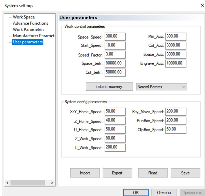
Для отображения действующих значений параметров, необходимо нажать кнопку “Read”, а после внесения изменений “Save” (пароль для подтверждения внесённых изменений “608”) и перезагрузить систему (клавиша “Reset” на пульте управления).
