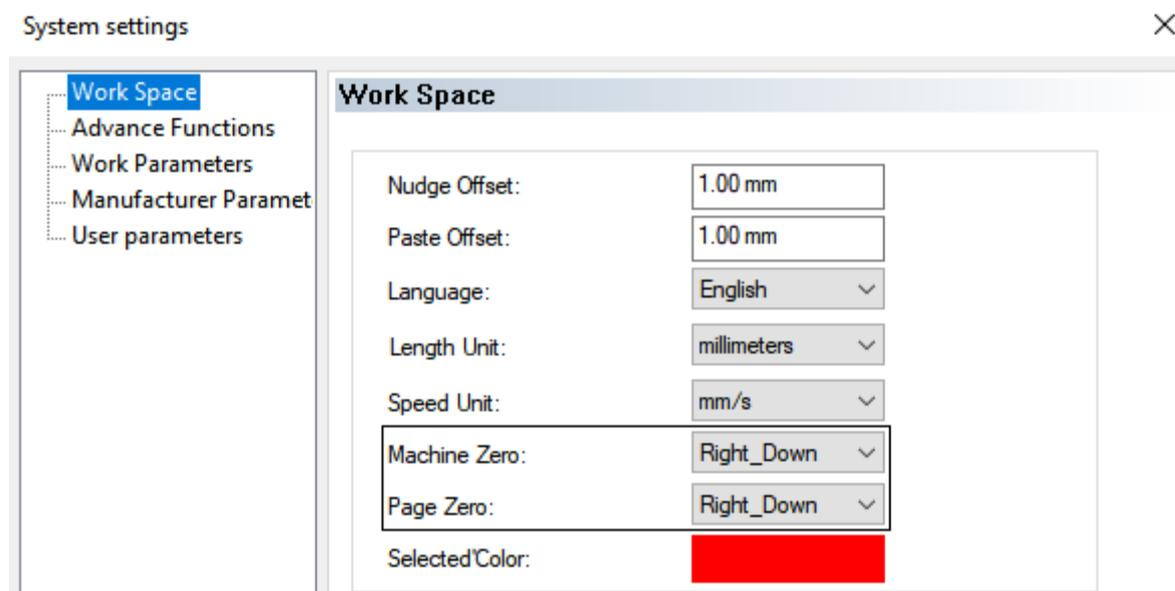
а также воспользоваться функциями меню “Options>>Position Relative” и настроить параметры расположения лазерной головки (Position Relative) с учётом расположения домашнего положения лазерного станка.
