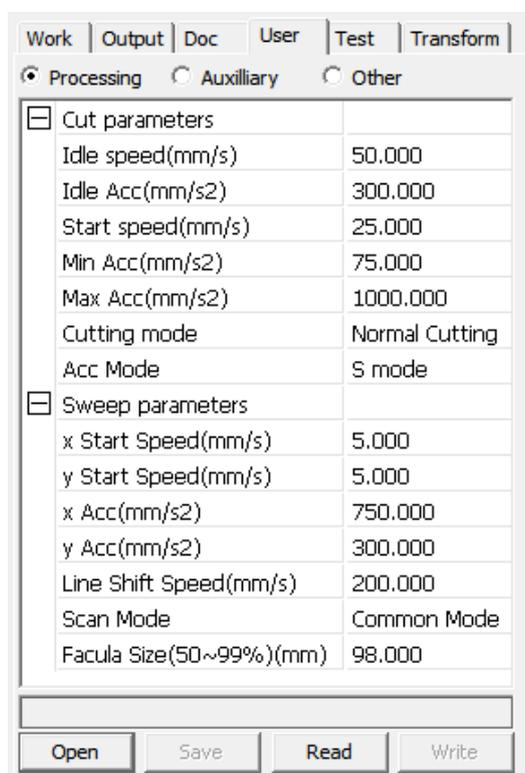
Для отображения действующих значений параметров, необходимо нажать кнопку “Read”, а после внесения изменений “Write” и перезагрузить систему (клавиша “Reset” на пульте управления)
