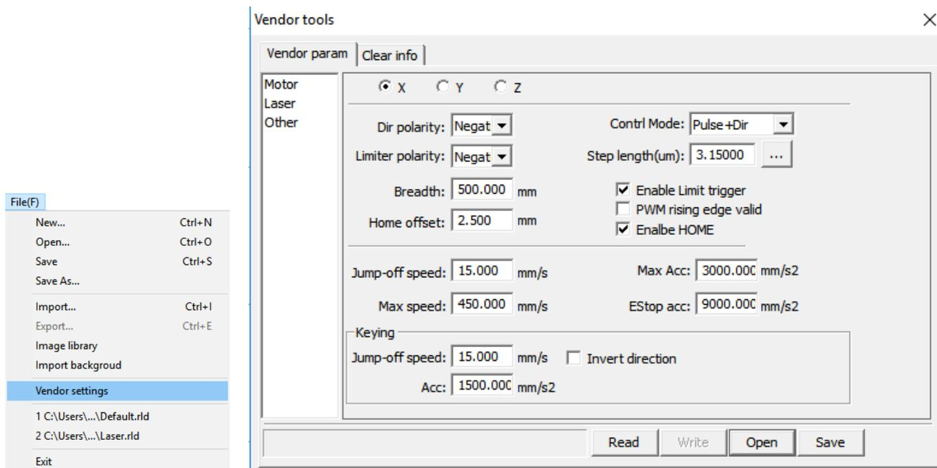
Параметры группы “User Setting” находятся в группе параметров на вкладке “User”. Считываем текущие параметры контроллера “Read”, выбираем файл профиля “Open”, затем “Write”.
