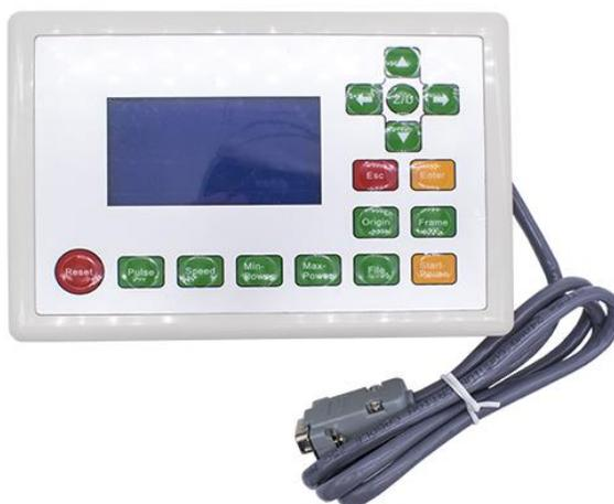
При работе с лазерным станком удобно использовать пульт управления RuiDa RDLC320-A. Пульт управления имеет 16 функциональных кнопок.
