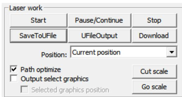
Для загрузки управляющей программы в память контроллера с помощью USB-флеш-накопителя необходимо создать файл в формате “rd” с помощью меню “SaveToUFile” в группе “Laser work”, сохранить его на флеш-накопитель, отформатированный предварительно в формате FAT32 (**ВАЖНО** использовать полное форматирование, т.е. необходимо выключить функцию “Быстрое (очистка оглавления)”) и перенести в память контроллера используя разъём “USB” на панели оператора.
