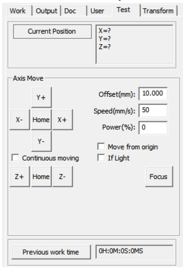
С помощью группы параметров “Axis Move” возможно перемещать лазерную головку по рабочему полю станка, возвращать её в начальное положение “Home”. В случае если была проведена процедура определения домашнего положения лазерного станка по соответствующим осям, движение портала будет ограничено заданными размерами рабочего пространства.
