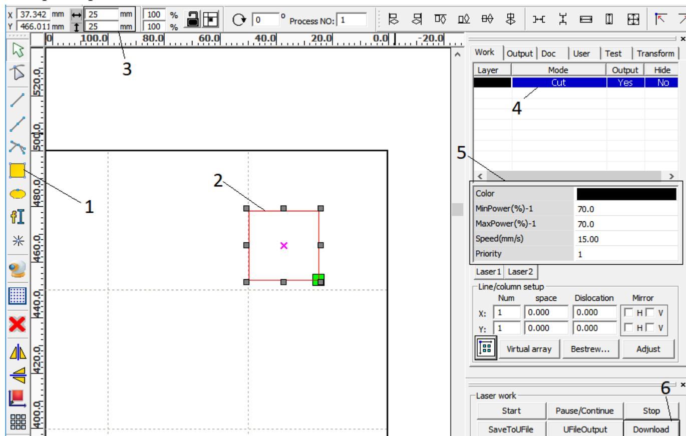
Разработчик лазерного станка предварительно настраивает контроллер управления и сохраняет параметры в специальных файлах профиля (“user.RDUSet” и “vendor.RDVSet”), которые предоставляются заказчику. В процессе работы с лазерным станком может потребоваться восстановить параметры контроллера управления. Для этого необходимо загрузить файлы профиля с настройками в память подключённого по USB контроллера управления к ПК с помощью программного обеспечения RDWorks.
